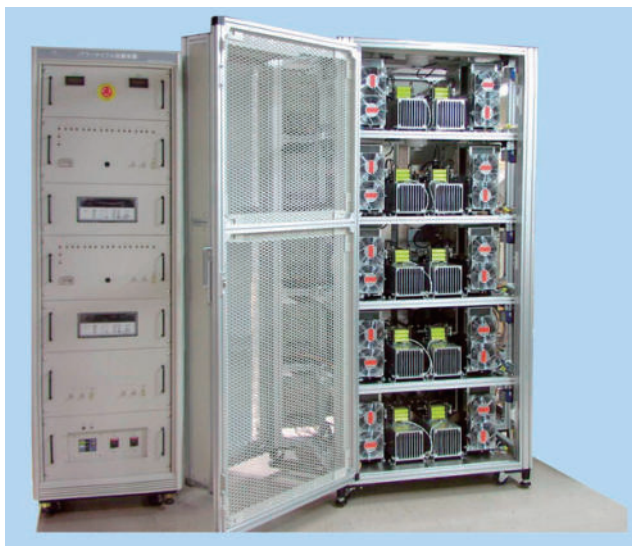
パワーサイクル試験装置
