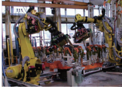
自動溶接組立設備
